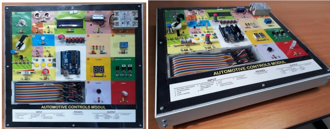
Gambar 2. Tampilan peraga pendidikan training kit dasar sistem kontrol elektronik otomotif
